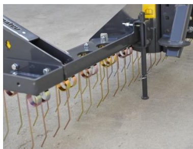
- zabudovaná podpora umožňuje jednoduchou montáž a výměnu prutů
